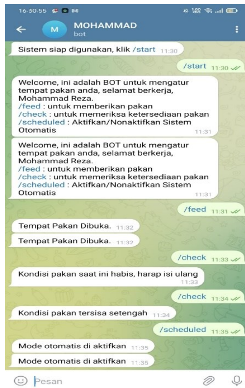
Gambar 7. Tampilan Telegram Messenger Terkoneksi Dengan Wemos D1 R1
