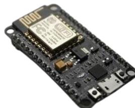
Gambar 2. NodeMCU ESP8266
