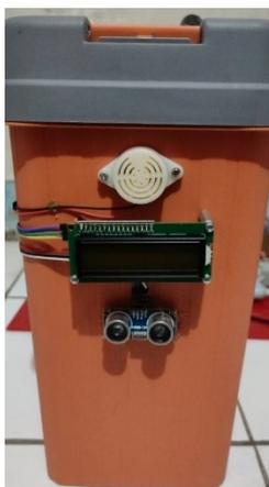
Gambar 7. Rancangan Alat Tempat Sampah Otomatis
