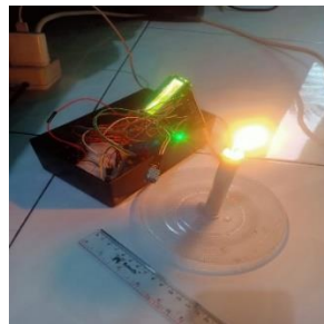
Gambar 11. Pengujian Sensor api pada jarak 5 Cm
