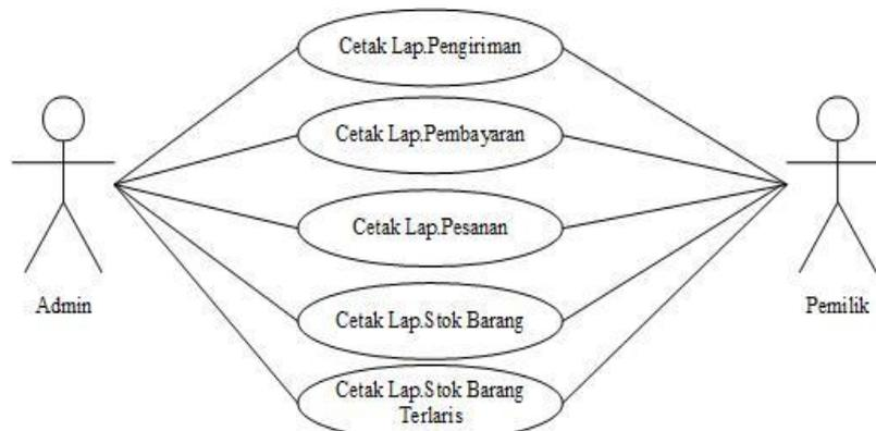
**Gambar 6 Use Case Diagram Laporan**
