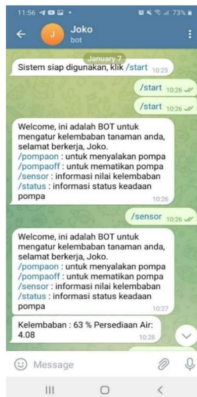
**Gambar 6.** Tampilan Telegram Messenger Terkoneksi Dengan NodeMcu
