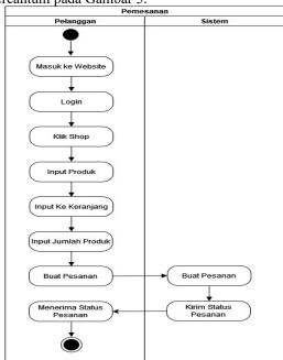
Gambar 5. Activity Diagram Sistem Usulan Pemesanan
