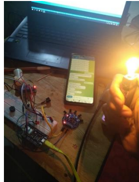
Gambar 7. Pengujian Sensor Api Pada Ruangan
