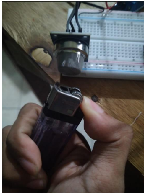
Gambar 8. Pengujian Sensor Asap Pada Ruangan
