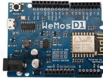
Gambar 1. Board Mikrokontroler WeMos D1
