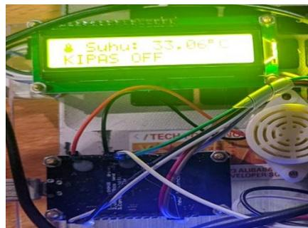
Gambar 9 Tampilan LCD Setelah di input Program
